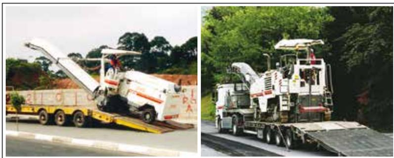
**Figura 38:** Carretas apropriadas para o transporte de fresadoras
