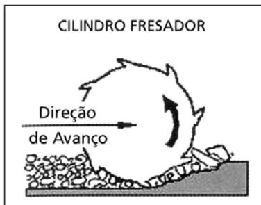
**Figura 20:** Sentido de giro do cilindro fresador
