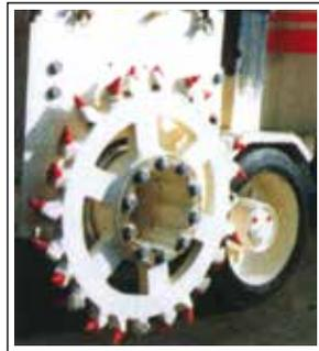
**Figura 19:** Anel de corte acoplado externamente ao equipamento
