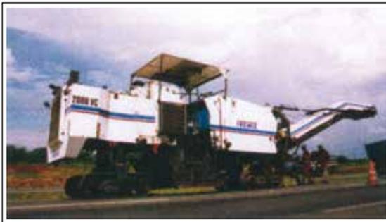
**Figura 55:** Fresadora 2000 VC, da Wirtgen
