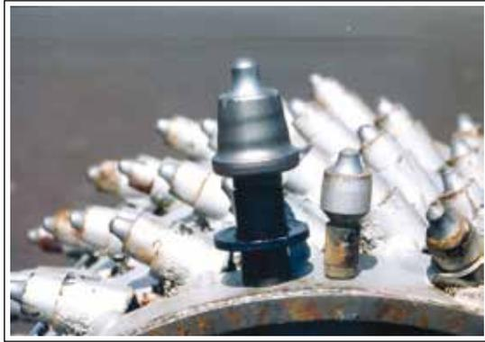
**Figura 10:** Comparação entre os dentes de fresagem padrão e microfresagem
