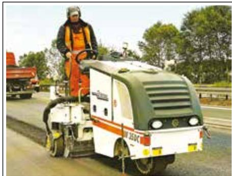
**Figura 4:** Fresadora W 35 DC, da Wirtgen, sobre três rodas
