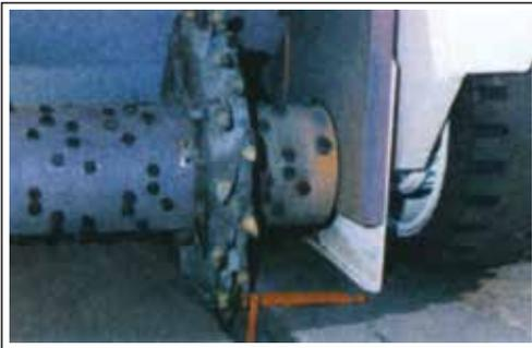
**Figura 18:** Anel de corte acoplado diretamente no cilindro fresador
