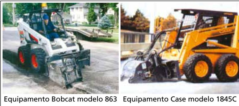
**Figura 33:** Unidades de fresagem acopladas aos equipamentos
