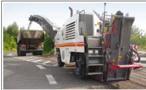
**Figura 29:** Fresadora W 100 F, da Wirtgen, apoiada sobre pneus
