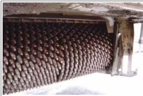
**Figura 12:** Cilindro especial de microfresagem dotado de 1.080 dentes
