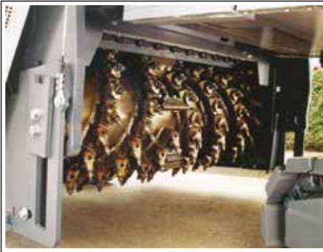
**Figura 16:** Cilindro fresador do modelo W 1900 com sistema de troca rápida
