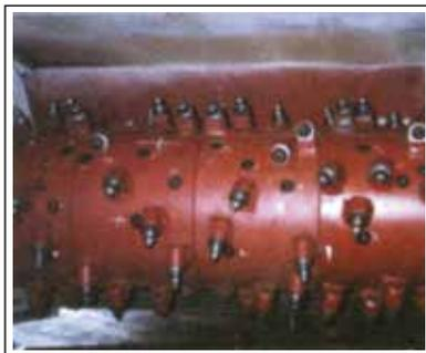
**Figura 14:** Cilindro fresador com sistema segmentado
