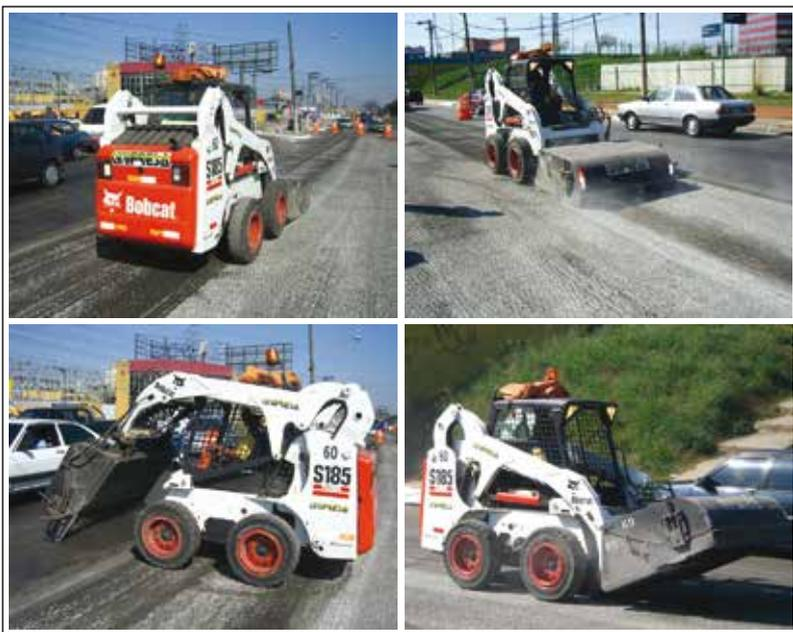
**Figura 37:** Equipamento bobcat equipado com vassoura mecânica
