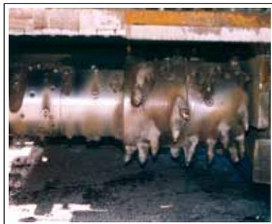
**Figura 15:** Fresadora SF 1000 C adaptada para execução de fresagem na largura de 500 mm
