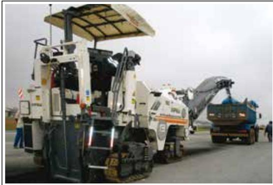
**Figura 26:** Fresadora W 1000 F, da Wirtgen, com carregamento frontal
