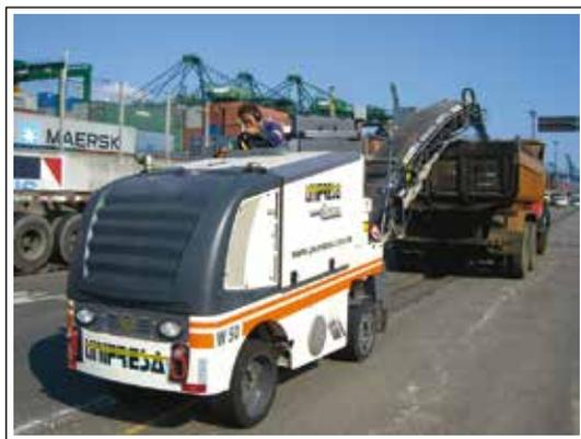
**Figura 5:** Fresadora W 50, da Wirtgen
